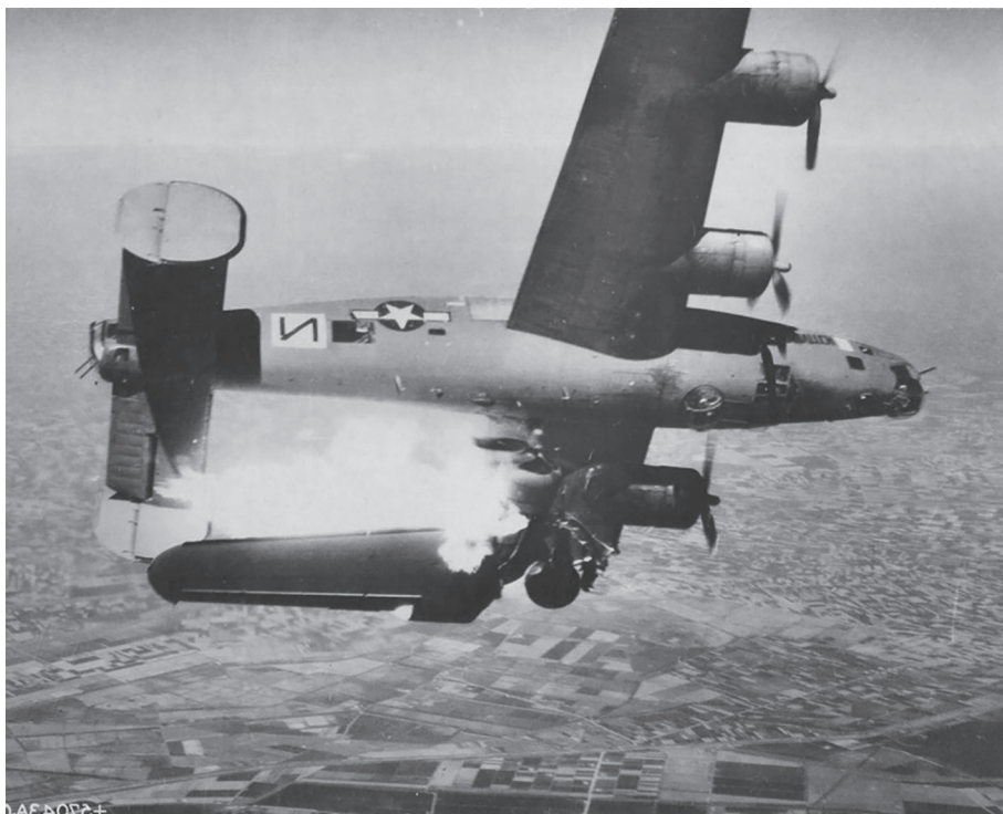
Slika 1: Letalo B-24J ob zadetku protiletalskega topa. Kljub verjetno majhnemu kalibru izstrelka nosilec krila poškodbe ni prenesel in se je zlomil. Zlom glavnega krilnega nosilca ob poškodbi krila je bila ena večjih hib letala B-24 (vir: splet 1, open source).
