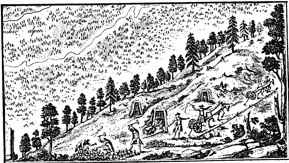
Slika 4. Del Pohorja nad Mislinjskim grabnom, torej visoko nad Zoisovo fužino s plavžem. Upodobljena (idealizirano?) so tri opravila: izvoz rude iz jame, razbijanje večjih grud rude, dovoz rude iz drugih jam na delovišče (točneje: odhod praznih voz). Obe enoosni vozili — na Kranjskem so takemu vozilu rekli kripa — imata med kolesi železno zavorno palico. Na desni strani obeh vozil je cev za vodo, da so mogli prati rudo kar pri rudnikih. Gozd okoli rovov ali jam je že razredčen, ker so debela uporabili kot jamski les, dalje v fužinske namene (lope, jezovi, ostrešja) in za kuhanje oglja. — Slika je Tab. 6 v Balthasar Hacquetovi Oryctographiji carniolijske, III, Leipzig 1784.
