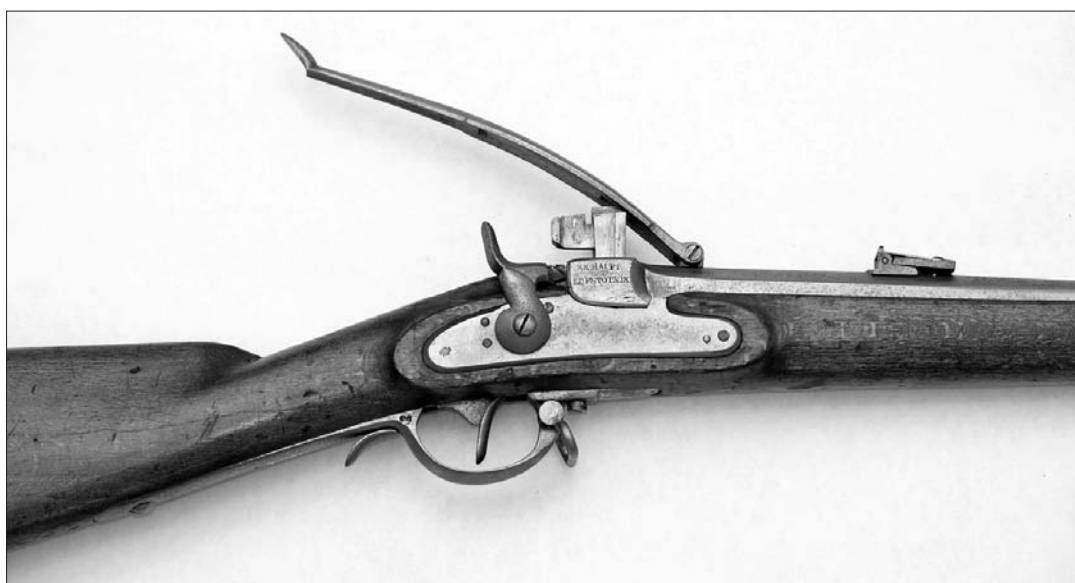
Zaklep puške v odprtem položaju (NMS, inv. št. N 36902, foto: Tomaž Lazar).
