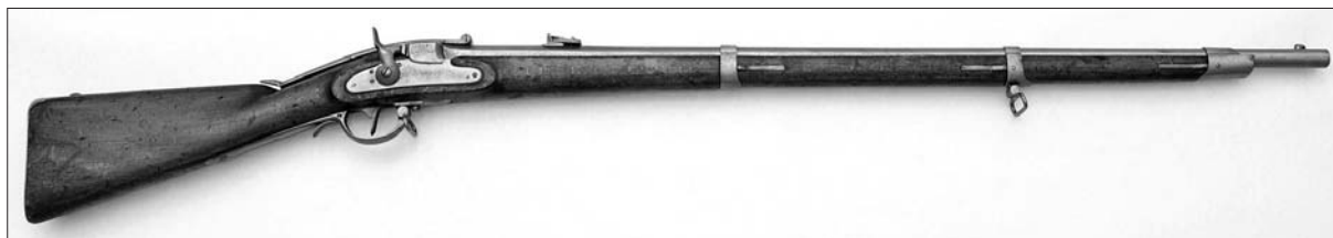
Puška M 1854 tipa Lorenz, leta 1860 predelana na zadnje polnjenje z enovitim nabojem po patentu Edmunda Pistotnika (NMS, inv. št. N 36902, foto: Tomaž Lazar).
